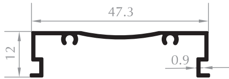
47'LİK DÜZ U 47 U PROFILE Kod/Code :PD1004 Ağırlık/Weight:0,220 kg/m
