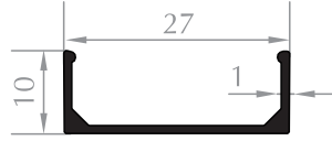
EŞİK PROFİLİ THRESHOLD PROFILE Kod/Code :SN2012 Ağırlık/Weight :0,135 kg/m
