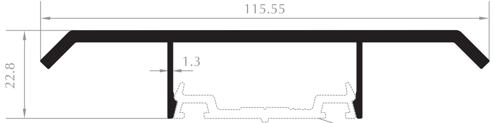
KAPAK PROFİLİ CAP PROFILE Kod/Code :CE3032 Ağırlık/Weight:1,128 kg/m
