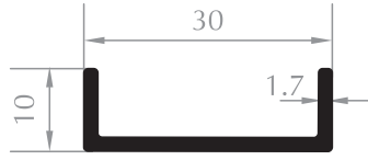
10x30 U PROFİLİ 10x30 U PROFILE Kod/Code :CE4007 Ağırlık/Weight:0,214 kg/m
