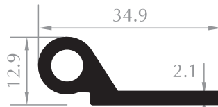
MENTEŞE PROFİLİ HINGE PROFILE Kod/Code :MB1016 Ağırlık/Weight:0,393 kg/m
