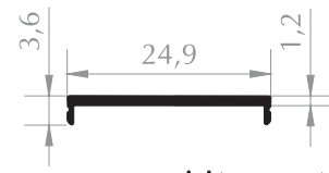
KAPAK PROFİLİ (MB1061) CAP PROFILE Kod/Code :MB1062 Ağırlık/Weight :0,089 kg/m
