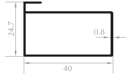
20x40 TIRNAKLI PROFİL 20x40 BOX PROFILE Kod/Code :MB1018 Ağırlık/Weight:0,285 kg/m
