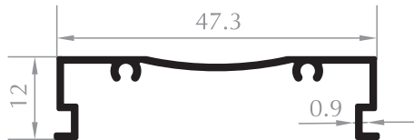
47'LİK DÜZ U 47 U PROFILE Kod/Code : PD1004 Ağırlık/Weight : 0,220 kg/m
