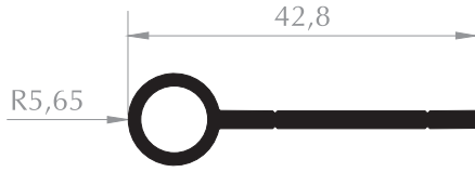
MENTEŞE PROFİLİ HINGE PROFILE Kod/Code : MB1040 Ağırlık/Weight : 0,315 kg/m
