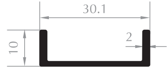
10x30 U PROFİLİ 10x30 U PROFILE Kod/Code :CE4004 Ağırlık/Weight:0,208 kg/m
