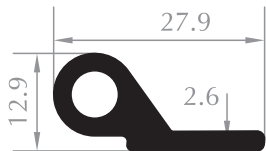
MENTEŞE PROFİLİ HINGE PROFILE Kod/Code :MB1015 Ağırlık/Weight:0,354 kg/m
